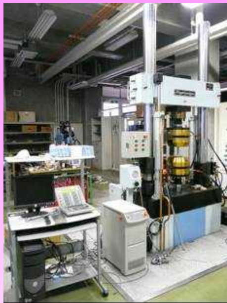
20ton電気油圧サーボ式疲労試験機
