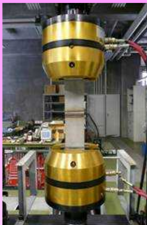
20ton電気油圧サーボ式疲労試験機
